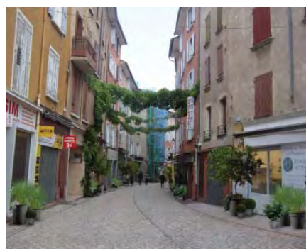
■ Continuité de revêtement clair beige (pierre, béton,...) de façade à façade, et écriture discrète du fil d'eau (1)
